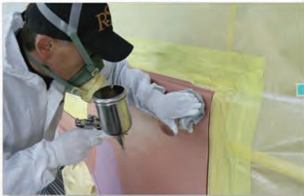
エアブローしながらタッチアップで毛髪などを取り除く。 補修箇所はカラープライマー部分
